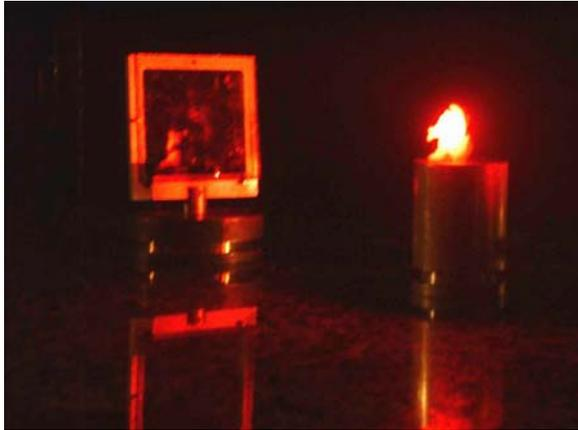
Replacer la plaque au même endroit (et dans le même sens) que lors de l'enregistrement. Retirer l'objet pour que la plaque soit éclairée seulement par le faisceau de référence. L'objet apparaît alors à travers l'hologramme à l'endroit où il se trouvait lors de l'enregistrement. En bougeant la tête, on le voit sous un angle différent.
