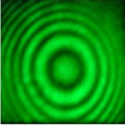
Ce montage permet de visualiser les interférences produites par un laser HeNe continu et un YAG doublé pulsé, pour une différence de marche variable de 0 à 1 m.
