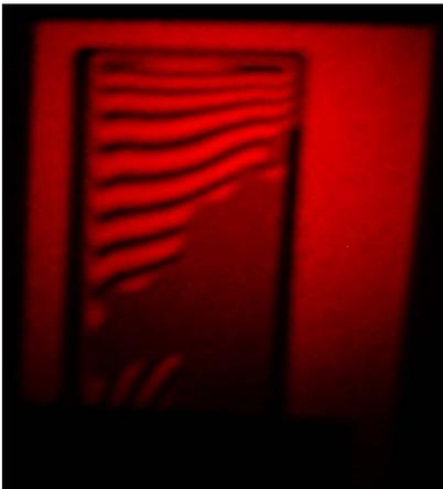
Ci-contre une photo des interférences obtenues en plaçant un objet opaque sur l'un des deux chemins optiques : les interférences ne se produisent que dans la zone de superposition des deux faisceaux sur l'écran, et non dans la zone d'ombre de l'objet.
