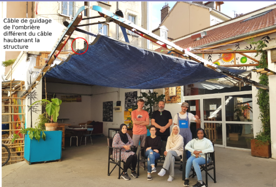
En fonctionnement normal, 2 câbles haubantent la structure. Un troisième, non tendu, est ajouté pour assurer toute défaillance des deux autres
